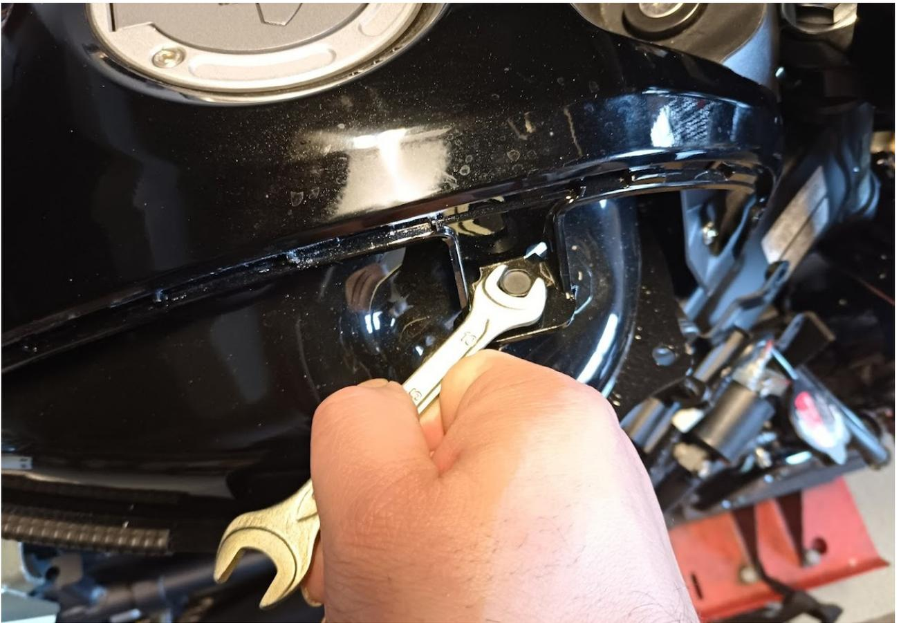
Démontage cache bobine haute tension :
