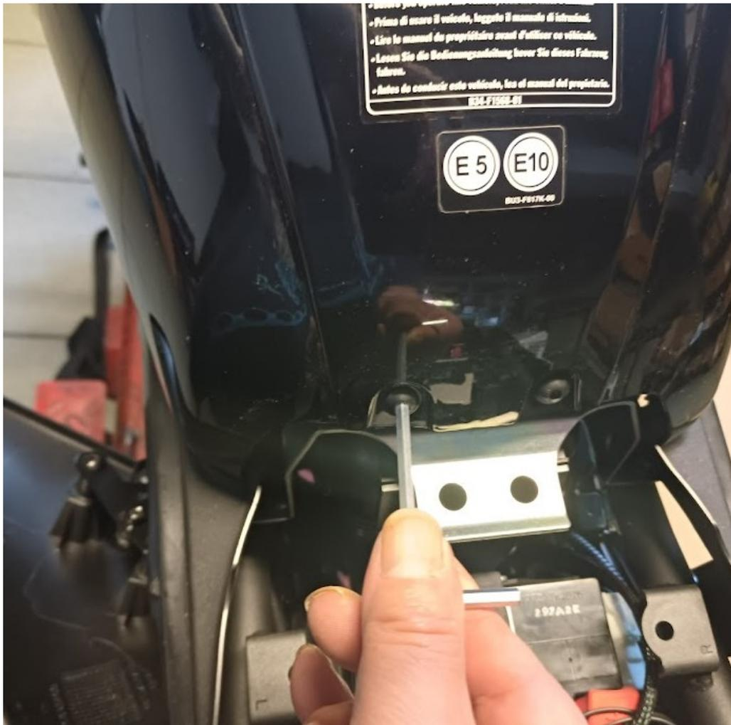
C) Démontage des caches carénage latéraux :
